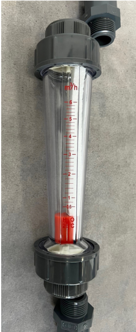
Vue de détail Débitmètre
