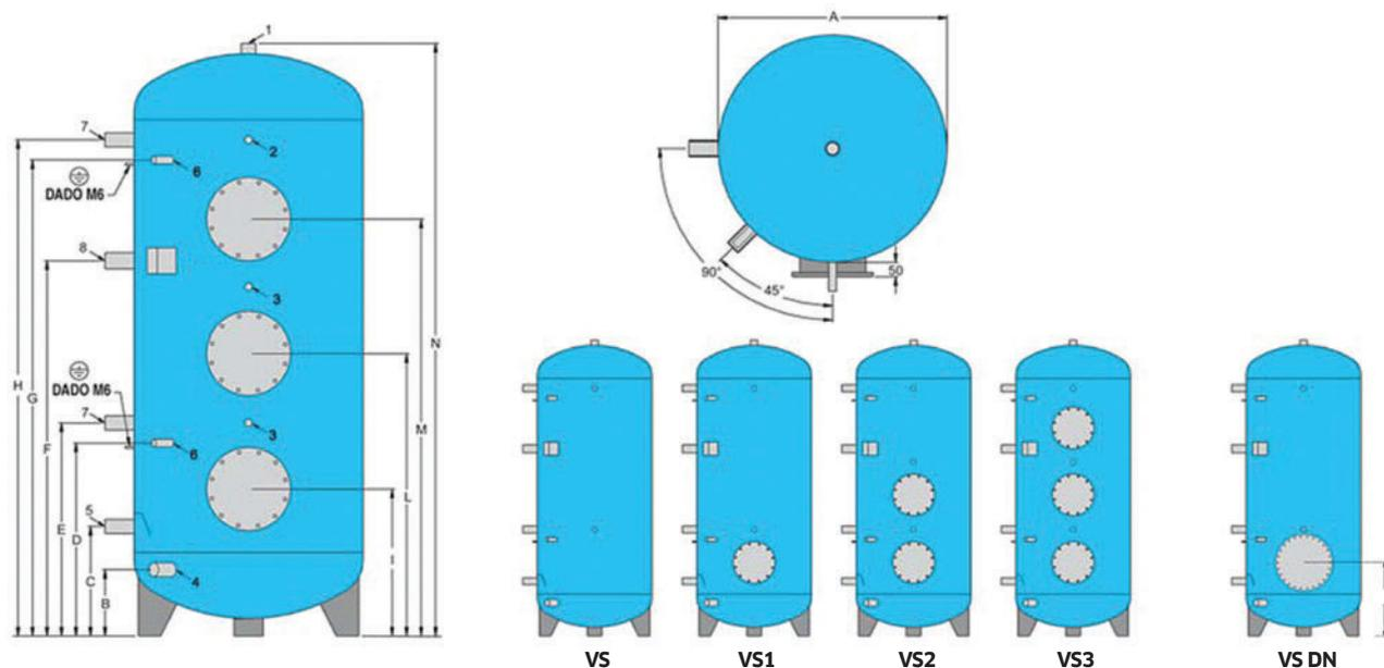
**VS : SMALGLASS** : ballon en acier haute qualité, complet avec anode de protection et protection intérieure contre la corrosion suivant norme DIN 4753-3 et UNI 10025.
