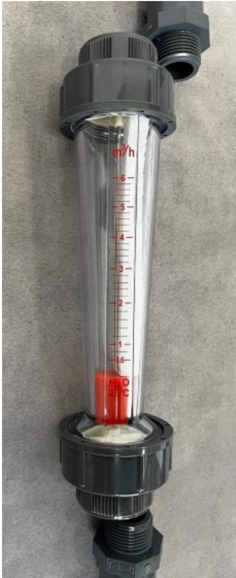
Vue de détail Débitmètre
